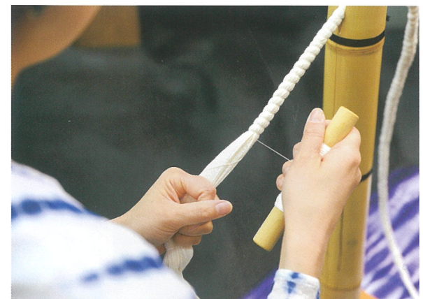
「手筋絞り」では、まず生地を縦方向に折り畳み、下巻き・上巻きと2段階に糸を巻き付ける。端まで巻き終わるとロープのような状態に。
