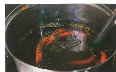
生地を一度水に通してから染色する。表に出た部分は染まり、内側は染まらないという原理だ。
