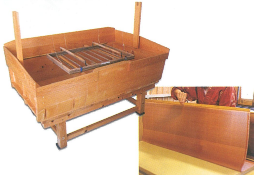
「本美濃紙」作りに欠かせない「すき舟」や「簀桁(すけた)」、「刷毛」。こうした伝統的な道具の作り手も減っているという。
