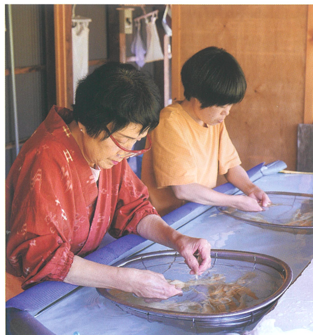
原料に付着したチリを手で一つひとつ取るなど、人手が必要な工程が多い。
